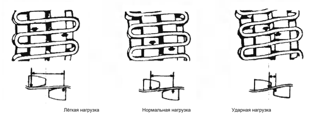
Слева направо: лёгкая, нормальная и сильная ударная нагрузка.
